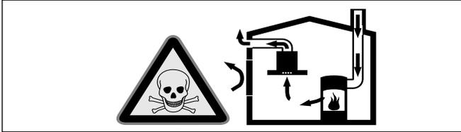
Les foyers à air ambiant (par exemples les chauffages à gaz, à bois, à fioul ou à charbon, les chauffe-eau instantanés, les ballons d'eau chaude) prennent l'air de combustion dans la pièce où ils sont installés et rejettent les gaz de fumée à l'air libre par un dispositif spécifique (cheminée par exemple).
