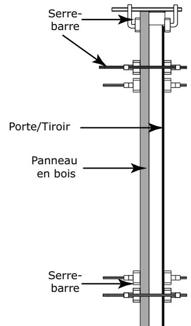
10. À l'aide d'un foret de 3 mm (7/64 po), percer 6 trous de guidage dans le panneau de bois de 12 mm (1/2 po) en utilisant les trous du cadre de porte ou du tiroir comme guide.
