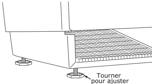
3. Confirmer que l'appareil est de niveau après chaque ajustement et répéter les étapes précédentes jusqu'à ce que l'appareil soit de niveau.
