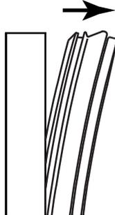
3. Continuer à tirer le joint pour le dégager de la rainure dans laquelle il est inséré.
