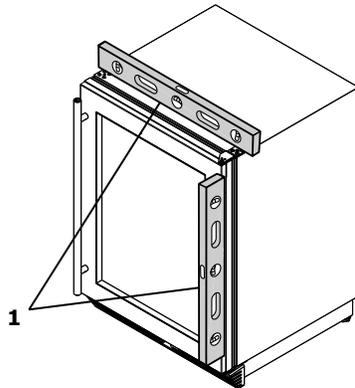
2. Si l'appareil n'est pas de niveau, régler les pieds aux coins de l'appareil selon les besoins.
