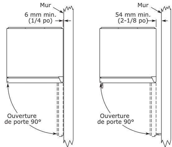
Les appareils ne nécessitent aucun dégagement pour ouvrir la porte à 90° lorsqu'ils sont installés à côté des armoires.
