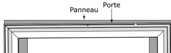
9. Fixer le panneau intégré à la porte ou au tiroir à l'aide de brides. On peut également utiliser un ruban adhésif extra fort. U-Line préconise d'utiliser des serres à barre pour fixer le panneau à la porte ou au tiroir. Si on utilise un ruban adhésif, s'assurer qu'il n'abîme pas la couche de finition du panneau lorsqu'on le retire.
