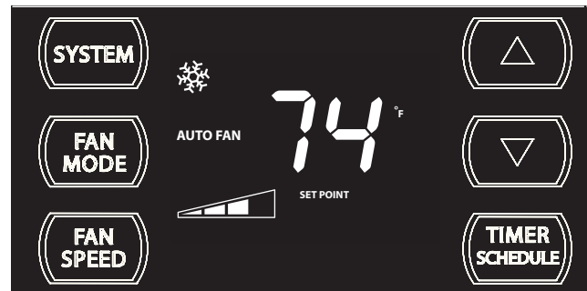
AUTO FAN (Cooling Demand)
