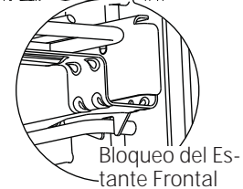
Sostenga el riel frontal superior y las manijas inferiores y empuje el estante hasta que la función de instalación se bloquee en el soporte frontal.
