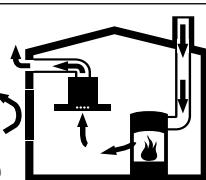
Raumluftabhängige Feuerstätten (z.B. gas-, öl-, holz- oder kohlebetriebene Heizgeräte, Durchlauferhitzer, Warmwasserbereiter) beziehen Verbrennungsluft aus dem Aufstellraum und führen die Abgase durch eine Abgasanlage (z.B. Kamin) ins Freie.
