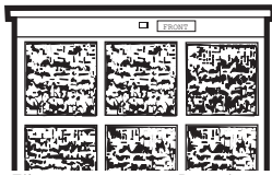
Filtre encrassé – Requiert un nettoyage
