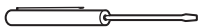
Petit tournevis à tête plate (tête de 4 mm ou 5/32 po., 60 mm. ou 2 3/8 po de long)
