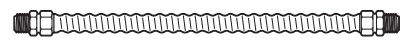
Línea de Gas Flexible Aprobada por CSA Diam. Int. Min. 3/8", Conexión NPT de 1/2", Longitud Máxima de 3 pies (Sólo en Massachusetts)
