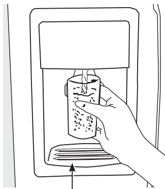
Bac de trop-plein
