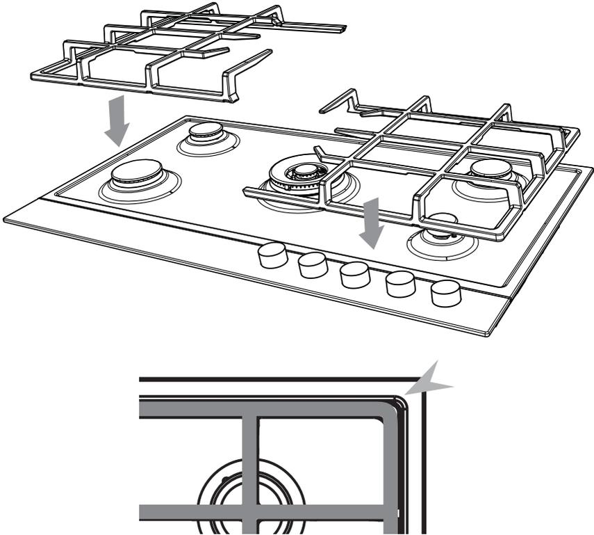
Fig.19 Positionnement adéquat des pièces d'appui
