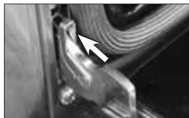
Fig. 25 Clip de retenue de charnière en position verrouillée
