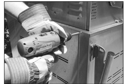
FIG.12 Fixez le gril à la partie arrière du chariot à l'aide de (2) vis phillips fournies (10-24 x 1/2 po).
