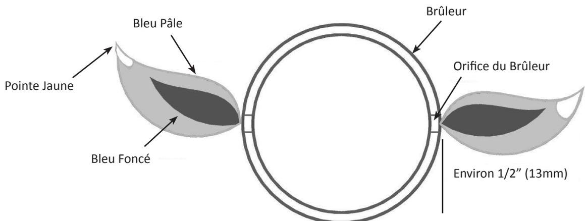
**Brûleur Tube:** Le brûleur est fait d'acier inoxydable 304, mais en raison de la chaleur extrême et d'un environnement corrosif, il se produira une corrosion de surface. Enlevez cette corrosion à l'aide d'une brosse en laiton. Nettoyez les orifices bouchés à l'aide d'un trombone déplié. N'agrandissez surtout pas les orifices du brûleur.
