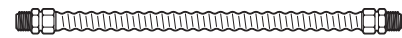
Línea de Gas Flexible Aprobada por CSA Diam. Int. Min. 3/8", Conexión NPT de 1/2", Longitud Máxima de 3 pies (Sólo en Massachusetts)
