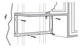
Pegue el plato a la pared usando los tornillos basculantes. Por lo menos un tornillo de madera debe ser usado para pegar el plato al poste de viga de la pared.
