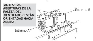
Ruede la unidad del soplador 90° de forma tal que las aberturas de la paleta del ventilador estén orientadas hacia el frente del microondas.
