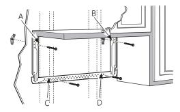
Pegue el plato a la pared usando los tornillos basculantes. Por lo menos un tornillo de madera debe ser usado para pegar el plato al poste de la pared. Las ubicaciones recomendadas sobre la placa de montaje se indican en A, B, C y D.
