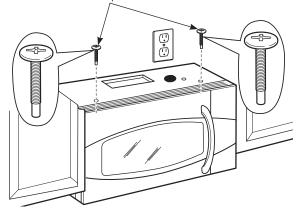
6 Apriete los dos tornillos exteriores hacia la parte de arriba del horno. (Mientras aprieta los tornillos, mantenga el horno en su lugar contra la pared y el gabinete superior.)
