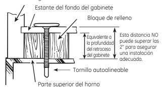
Apriete los dos tornillos exteriores hacia la parte de arriba del horno. (Mientras aprieta los tornillos, mantenga el horno en su lugar contra la pared y el gabinete superior.)
