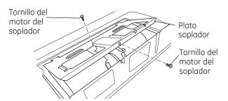
2 Cuidadosamente tire del soplador. Los alambres se extenderán lo suficiente como para permitirle que usted ajuste la unidad del soplador.
