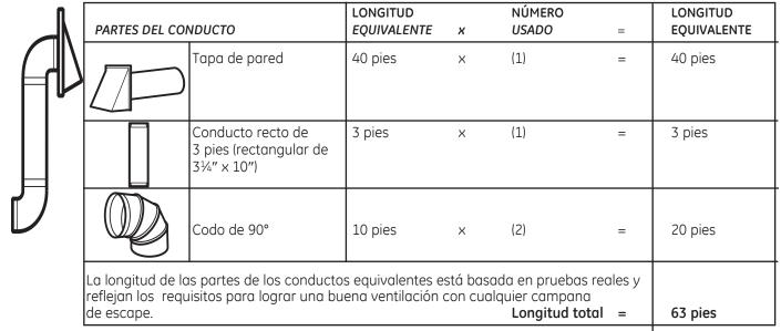
NOTA: Para el escape posterior, se debe tener cuidado al alinear el escape entre los espacios de los postes de viga de la pared, o la pared debería ser preparada en el momento de su construcción dejando suficiente espacio entre los postes de viga de la pared para acomodar el escape.
