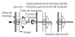
Coloque el plato de montaje contra la pared e inserte las alas de mariposa en los agujeros de la pared para montar el plato.
