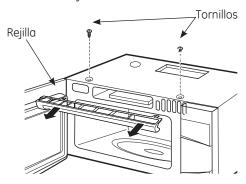
4 Inserte el filtro en horno como se muestra hasta que se ajuste correctamente en su lugar. Descansará en un ángulo detrás de las orejillas inferiores frontales. Cuando está instalado correctamente, la malla del filtro debería estar visible desde el frente.
