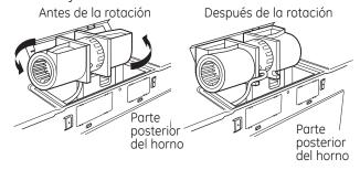
Suavemente remueva los alambres de las ranuras. Redirija los alambres a través de las ranuras en el otro lado de la unidad del soplador.
