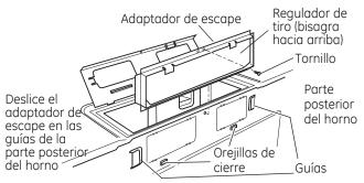
Empuje firmemente hasta que esté en las orejillas de cierre inferiores. Tanga cuidado de asegurarse de que la bisagra del regulador de tiro esté instalada de forma que esté en la parte superior y que el regulador de tiro gire libremente.
