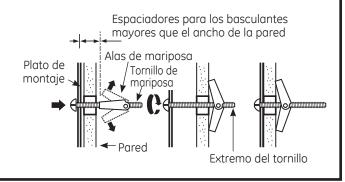
Coloque el plato de montaje contra la pared e inserte las alas de mariposa en los agujeros de la pared para montar el plato.
