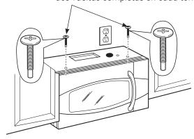
5 Apriete los dos tornillos exteriores hacia la parte de arriba del horno. (Mientras aprieta los tornillos, mantenga el horno en su lugar contra la pared y el gabinete superior.)
