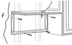
Pegue el plato a la pared usando los tornillos basculantes. Por lo menos un tornillo de madera debe ser usado para pegar el plato al poste de la pared.
