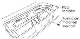
2 Cuidadosamente tire del soplador. Los alambres se extenderán lo suficiente para permitirle que usted ajuste la unidad del soplador.
