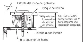
4 Inserte 2 tornillos (1/4"-28 x 2 5/4") autoalineables a través de los aquieros exteriores superiores del gabinete. Gire dos vueltas completas en cada tornillo.
