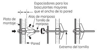
3 Coloque el plato de montaje contra la pared e inserte las alas de mariposa en los agujeros de la pared para montar el plato.
