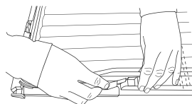
Fig.27 Insérez le couvercle sous les pièces de retenue latérales
