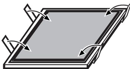
5. Réinstaller le filtre à graisse métallique. Voir "Filtre à graisse métallique" dans cette section.
