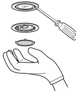
3. Enlever la lampe et la remplacer par une lampe à halogène neuve de 12 V, 20 W maximum, à culot de type G-4.
