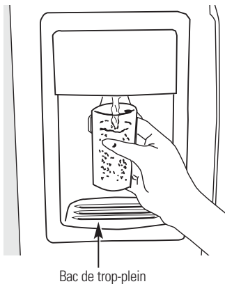
Bac de trop-plein
