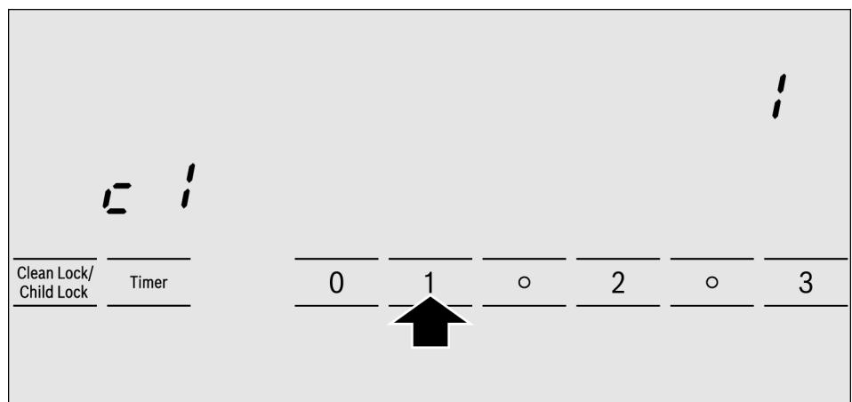
5. Appuyer à nouveau sur le symbole **Timer**, pendant plus de 4 secondes, jusqu'à ce qu'un signal de confirmation soit émis. Les réglages ont été correctement sauvegardés.
