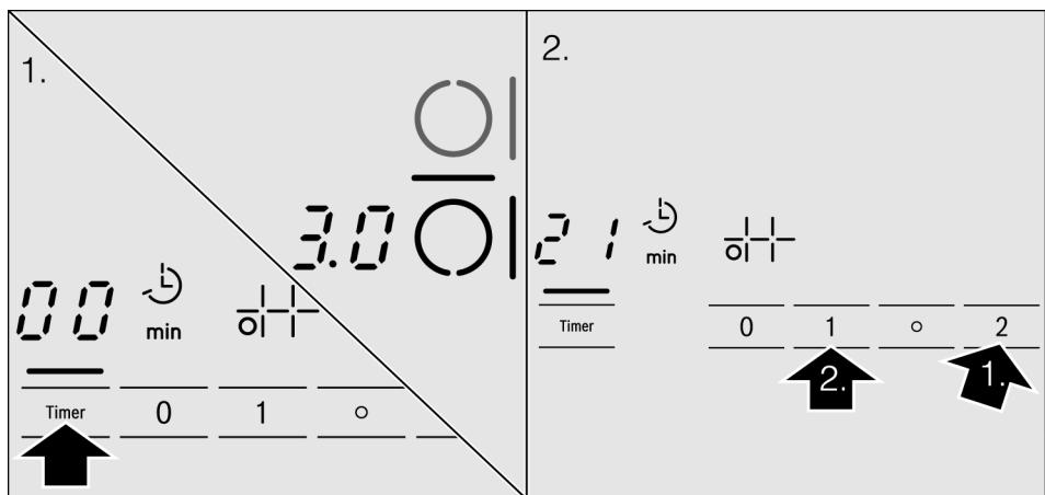
Au bout de quelques secondes, le temps programmé commence à s'écouler.
