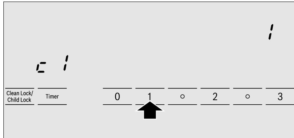
5. Volver a presionar el símbolo **Timer**, durante más de 4 segundos, hasta que suene una señal de confirmación. Los ajustes se habrán guardado correctamente.
