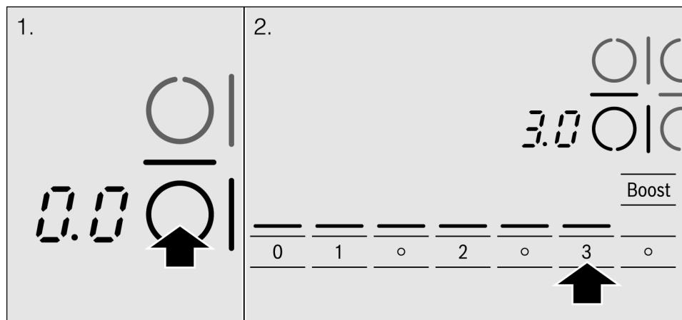
3. Modifier la position de chauffe : sélectionner la position de chauffe puis appuyer sur le symbole de la position de chauffe souhaitée. Pour sélectionner un niveau intermédiaire, appuyer sur le symbole  $\hat{U}$  situé entre les symboles des positions de chauffe.
