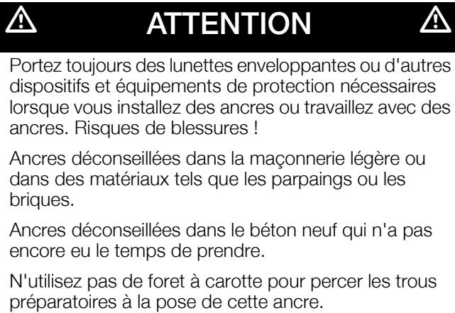
Utilisez une ancre M8 à béton et une vis M8 à béton. A titre d'utilisation additionnelle, des vis à bois accompagnent l'appareil, voir la vue d'ensemble «Utilisation des vis provenant du jeu de vis».
