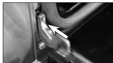
Fig. 08 Clip de retenue de charnière en position verrouillée
