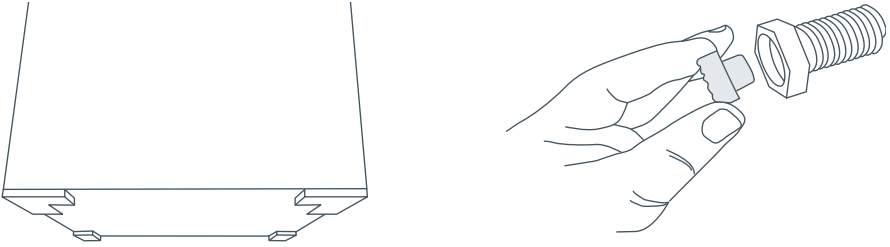
Dibujo 17 Colocación de los insertos de caucho
