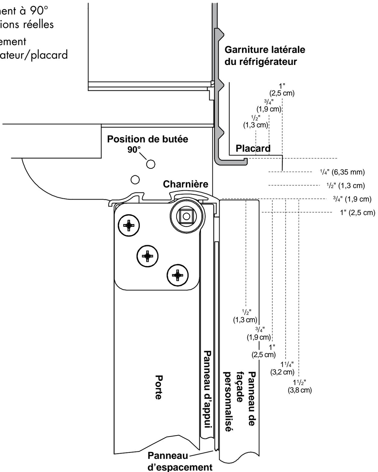
Prévoir un dégagement de 4 1/2" (11,4 cm) ou plus entre le côté du réfrigérateur et un mur d'angle. Un espace plus important peut être nécessaire si le réfrigérateur est doté de poignées personnalisées ou panneaux personnalisés plus épais. Ne pas oublier les plinthes.
