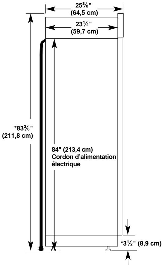
\*Lorsque les pieds de réglage de l'aplomb sont totalement déployés jusqu'à 1/4" (3,2 cm) au-dessous des roulettes, ajouter 1 1/8" (2,9 cm) (2,9 cm) aux dimensions de hauteur indiquées.
