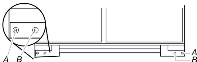
A. Boulon de réglage de l'aplomb (arrière)
