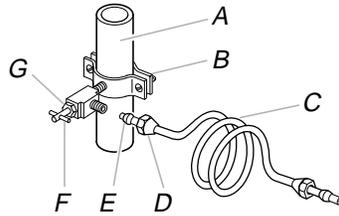
6. Fixer le robinet d'arrêt sur la canalisation d'eau froide avec la bride de tuyau. Veiller à bien insérer l'extrémité de sortie dans le trou de ¼" (6,35 mm) de la canalisation d'eau; veiller à placer correctement le joint sous la bride du tuyau. Serrer l'écrou de serrage. Serrer lentement et uniformément les vis fixant la bride de tuyau sur le tuyau afin d'assurer l'étanchéité du joint. Ne pas serrer excessivement pour ne pas déformer/écraser le tube de cuivre.
