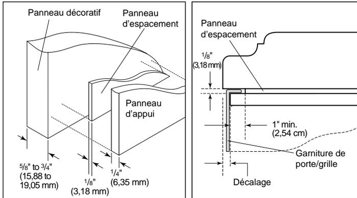
Dans certains cas, le fabricant des placards peut préférer travailler avec un seul panneau usiné pour les différentes dimensions. Pour un bon ajustement des panneaux personnalisés, suivre les dimensions indiquées ci-dessous, et appliquer les instructions appropriées pour le placement.
