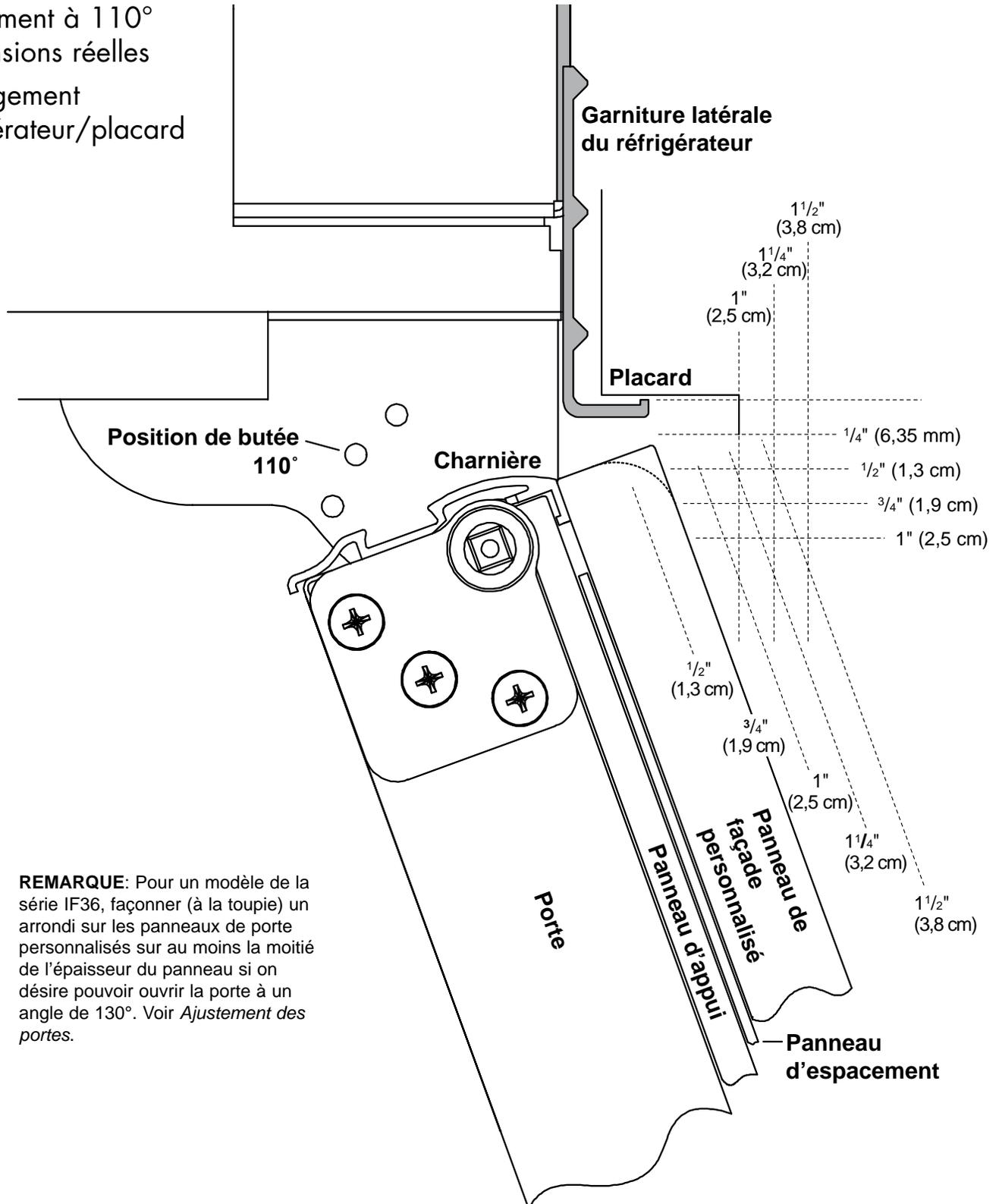
**REMARQUE:** Pour un modèle de la série IF36, façonner (à la toupie) un arrondi sur les panneaux de porte personnalisés sur au moins la moitié de l'épaisseur du panneau si on désire pouvoir ouvrir la porte à un angle de 130°. Voir *Ajustement des portes*.
