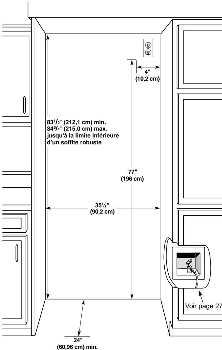
**REMARQUE :** Le plancher sous le réfrigérateur doit être au même niveau (affleurement) que le plancher de la pièce. Le devant du placard doit être droit.
