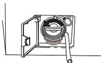
4. Ouvrir la pompe en dévissant le couvercle dans le sens inverse à celui des aiguilles d'une montre. Retirer l'ensemble couvercle et filtre.
