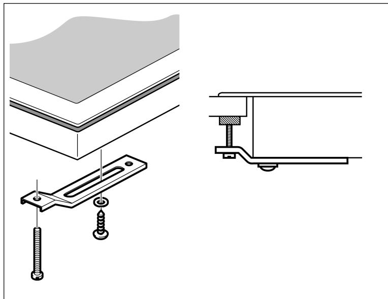
La placa debe asegurarse a la superficie de trabajo con los soportes de sujeción provistos.
