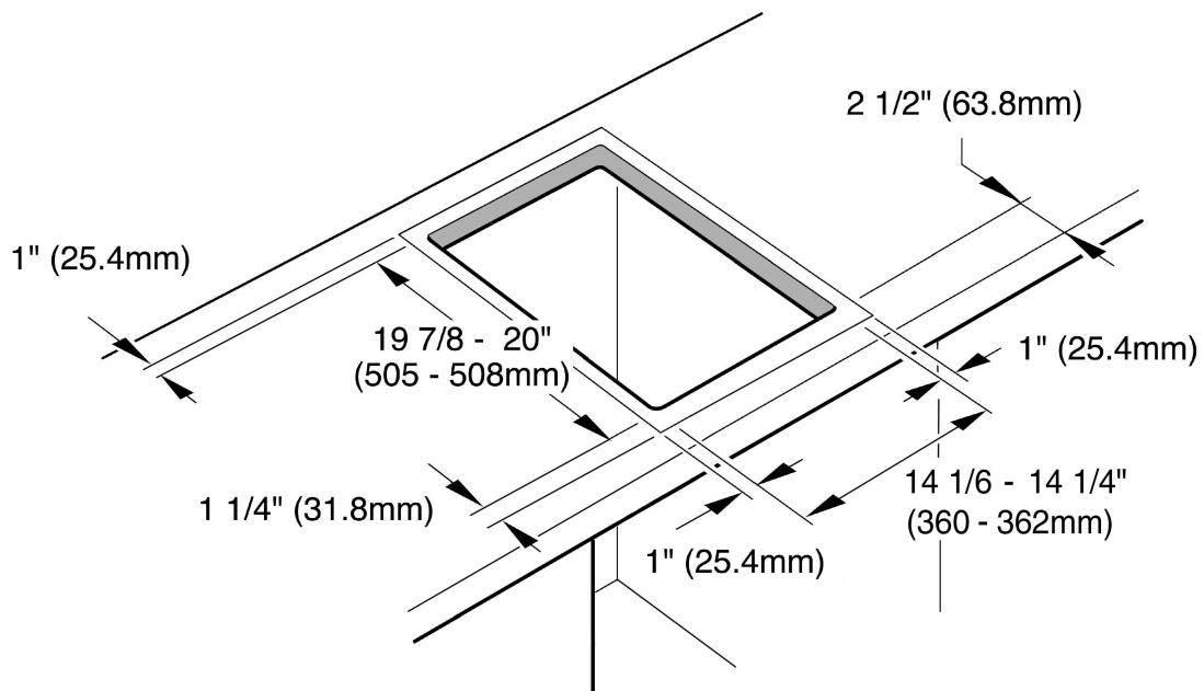
Après avoir préparé la cavité, enlever les copeaux pour éviter qu'ils ne gênent le fonctionnement des composants électriques de l'appareil.
