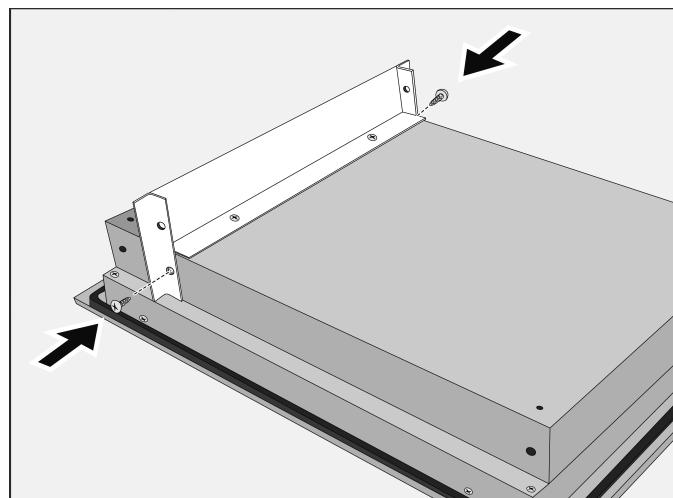
Atornillar los deflectores laterales en los agujeros situados en los dos lados de la chapa envolvente, tal y como se muestra en la imagen. Los dos tornillos adicionales se encuentran en la bolsa de la documentación del aparato.
