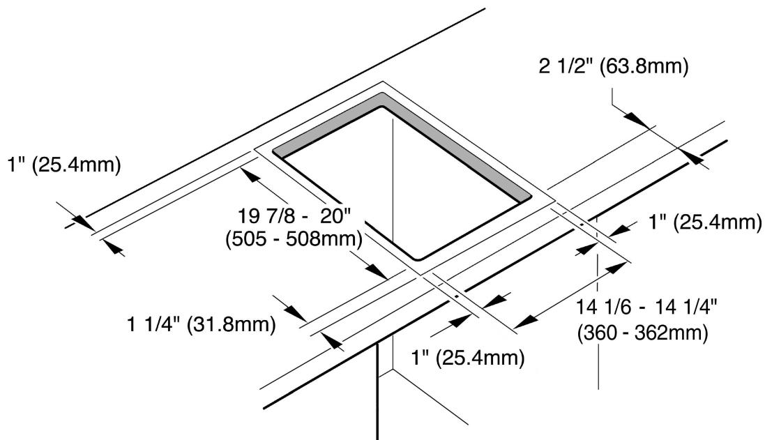
Después de preparar el hueco, retire las virutas, ya que pueden afectar el funcionamiento de los componentes eléctricos.
