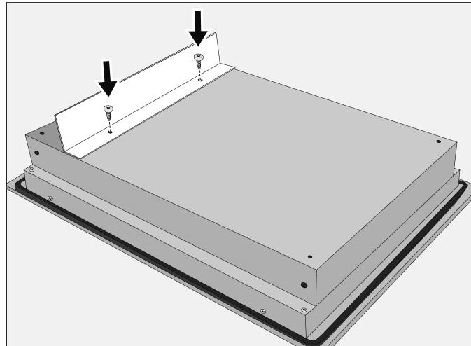
Vissez le déflecteur métallique frontal dans les orifices situés sur la base de la tôle enveloppante, de la manière indiquée sur l'image.
