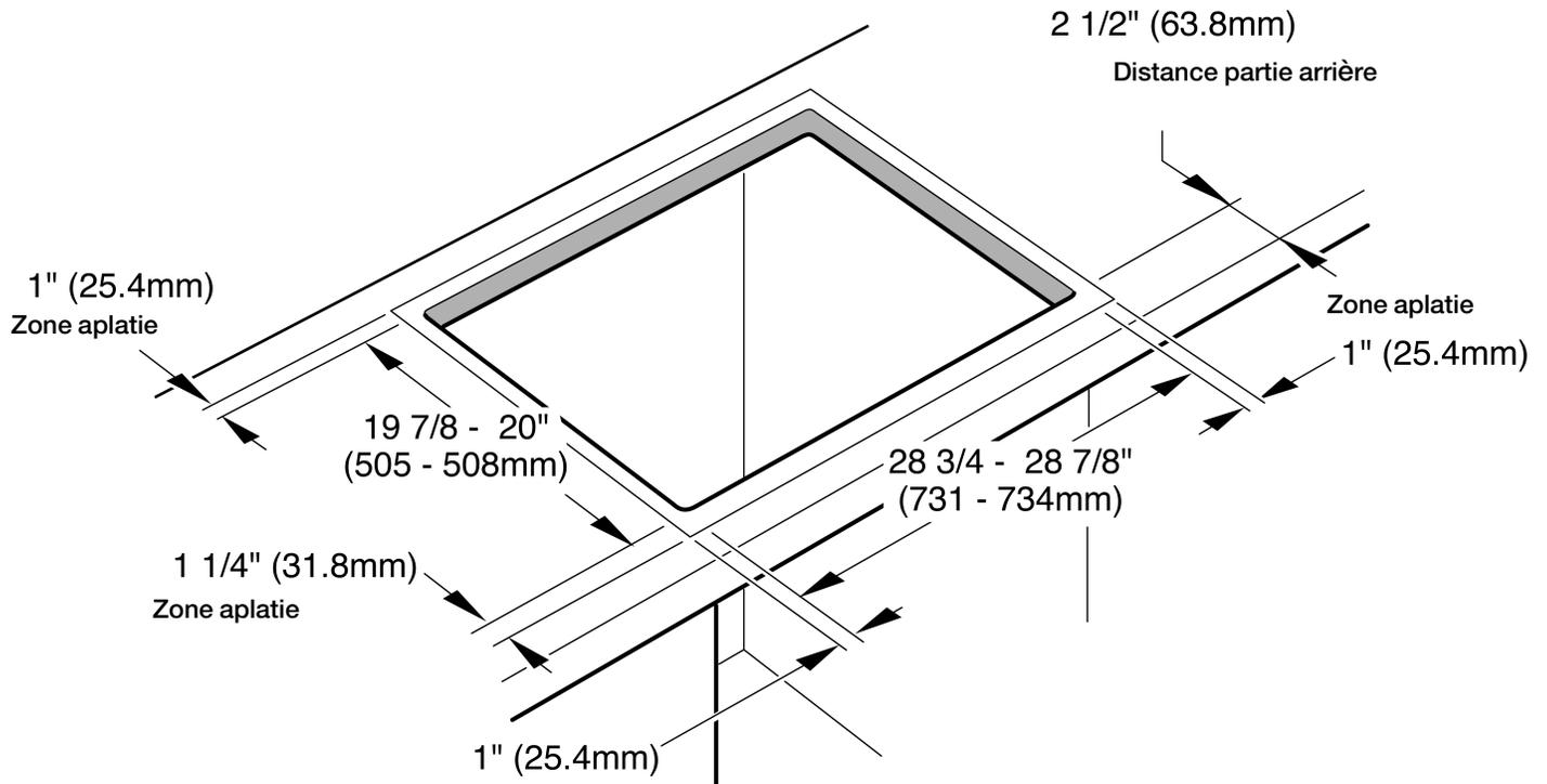
Après avoir préparé la cavité, enlever les copeaux pour éviter qu'ils ne gênent le fonctionnement des composants électriques de l'appareil.
