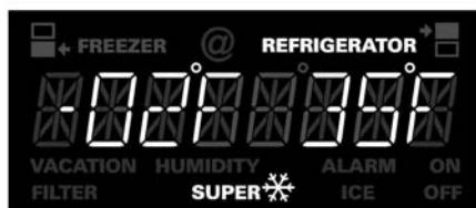
Se visualiza el símbolo **SUPER \*** **REFRIGERATOR** y la temperatura correspondiente en el display.
