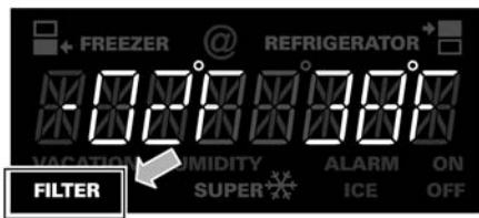
Cela signifie que la durée de vie maximale du filtre est sur le point d'expirer. Veuillez commander un nouveau filtre «UltraClarity».
