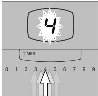
2. À l'intérieur de 5 secondes, glissez votre doigt sur le tableau à glissement jusqu'au réglage de la chaleur désirée sur l'affichage de l'élément.
