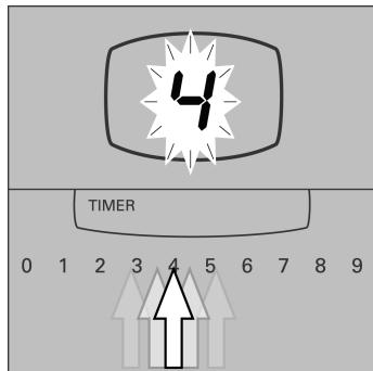
2. En los siguientes 5 segundos, deslizar el dedo sobre el panel numérico hasta que el nivel de potencia deseado aparezca en el indicador de la zona de cocción.
