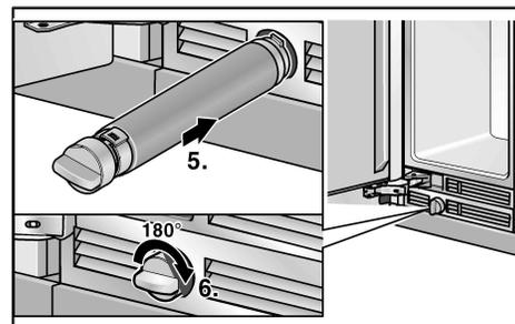
**5.** Présentez la cartouche filtrante à l'horizontale et poussez-la avec le couvercle complètement dans l'orifice ménagé dans le panneau de base.
