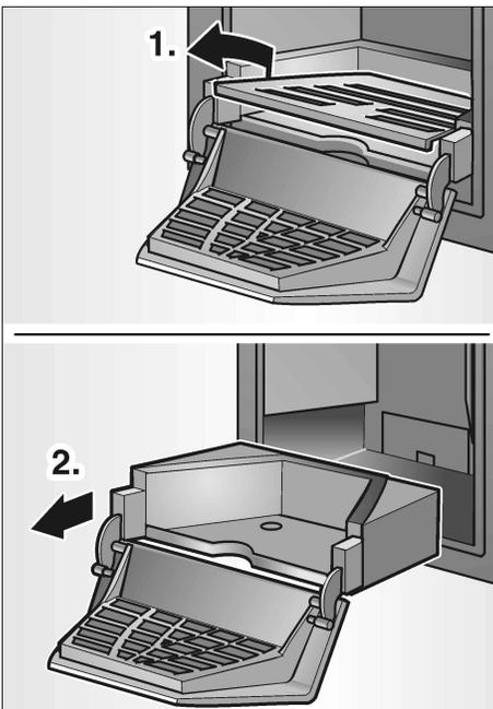
El agua derramada se junta en la cubierta del soporte para la jarra. Puede quitarse el colector de la cubierta tirando de él, a fin de vaciarlo.
