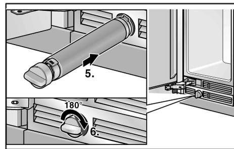
5. Empuje el elemento filtrante en posición horizontal totalmente dentro de la abertura en el panel base.
