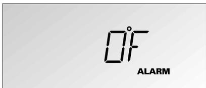
Une alarme de température se signale par le clignotement de la température requise et l'allumage du symbole **ALARM**. Un signal retentit également si vous avez activé la fonction SIGNAL SONORE dans le mode Configuration.
