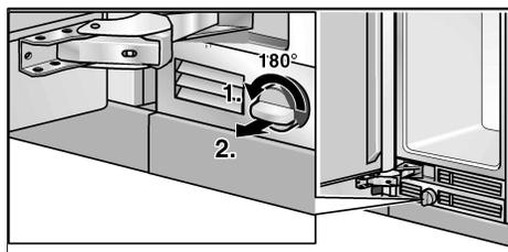
**1.** Faites tourner le couvercle du filtre de 90° à 180° en sens inverse des aiguilles d'une montre. Ce couvercle se trouve sur le panneau de base.
