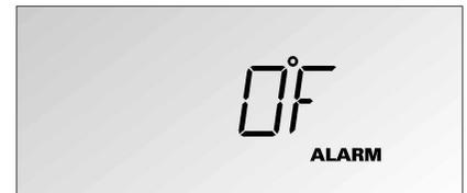
Se indica una alarma respecto de la temperatura a través de una visualización intermitente de la misma y el encendido de la señal de ALARM(a). También suena un sonido de alarma, siempre que esté activado este método en el modo de setup.
