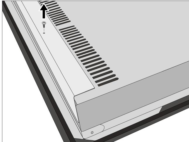
Tras desempaquear la placa, desatornillar el deflector metálico (ver imagen).
