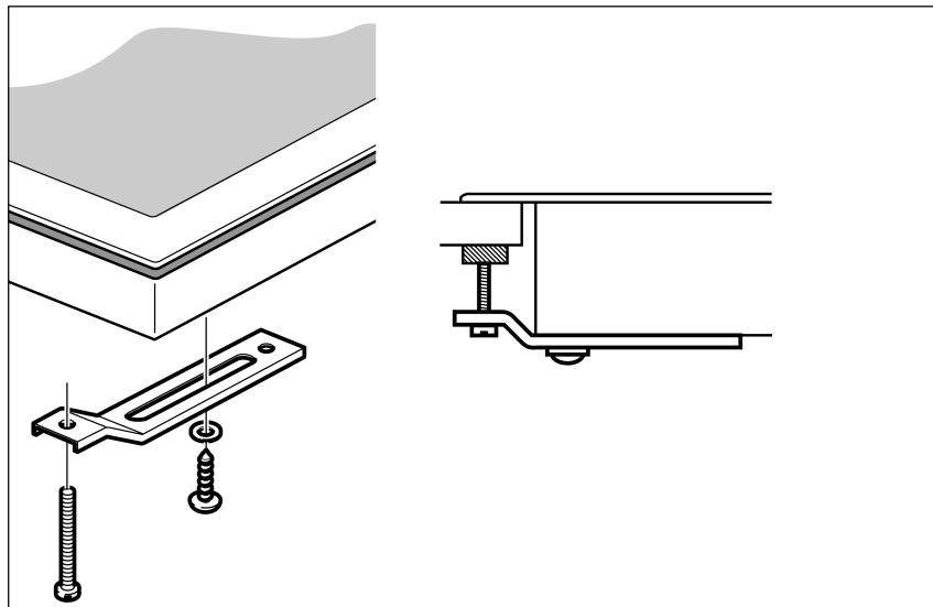
La placa debe asegurarse a la superficie de trabajo con los soportes de sujeción provistos.
