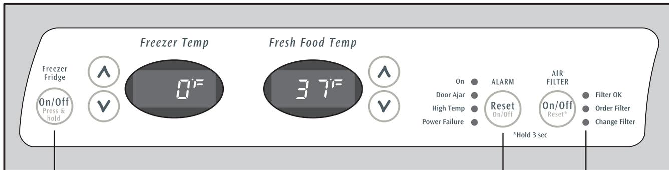
Tecla "On/Off" (Encendido/Apagado) del sistema de enfriamiento
