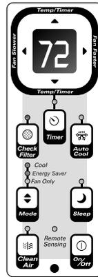
Nota: Presione o mantenga presionado el botón arriba (^) o abajo (v) hasta que la temperatura deseada se visualice en pantalla. Esta temperatura será automáticamente mantenida en cualquier lugar entre los 60F (16C) y 90F (32C). Si quiere que el visualizador muestre la temperatura actual de la habitación. Vea la sección "Operar Sólo el Ventilador" en la página 7.
