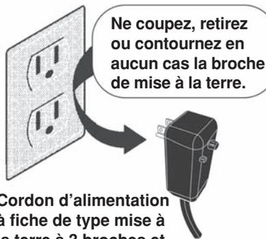
Cordon d'alimentation à fiche de type mise à la terre à 3 broches et dispositif de détection
